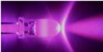
التآلق الضوئي لدايود ضوئي مصنوع من مادة نتريد الغاليوم
